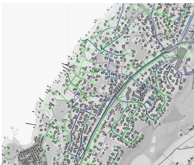
Figur 25: Ledningsnett Saltnes strandsone.
